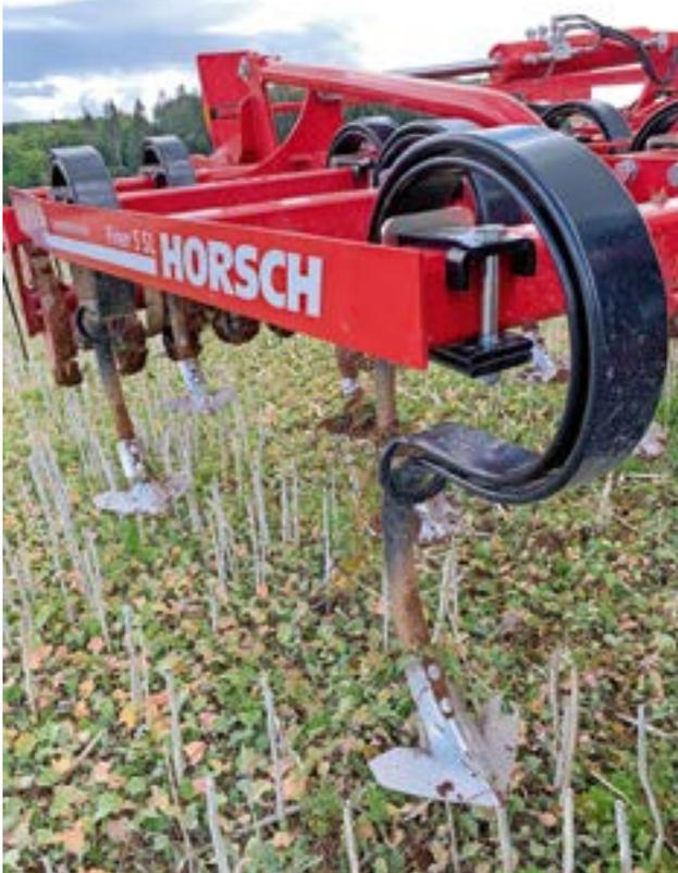
**Doppelfederzinken, wie hier am Finer 5 SL von Horsch, sorgen auch bei sehr harten, trockenen Böden für ausreichend Stabilität und halten den Zinken gut im Boden.**
