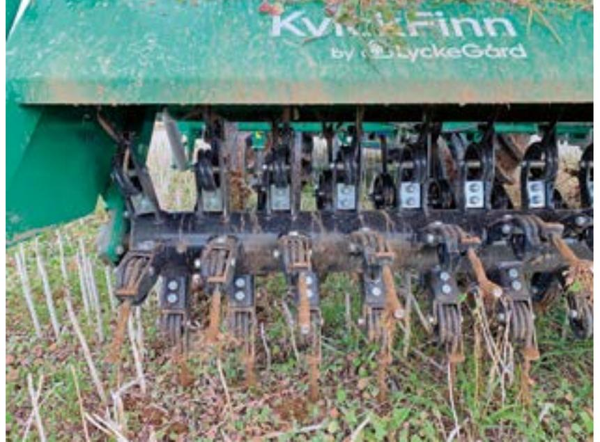
Der gewundene Zinkenrotor des KvikFinn sorgt für Laufruhe. Faustgroße Steine stellen kein Problem dar. Generell sollte bei der Bestellung nicht auf die hydraulische Heckklappe als Option verzichtet werden.
