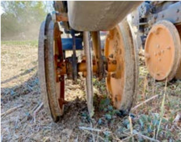
Beim Breitscharhobel HS ist jedes Schar parallelogrammgeführt. Die Scheiben lassen das Schar der Kontur des Feldes folgen und zerkleinern organisches Material.
