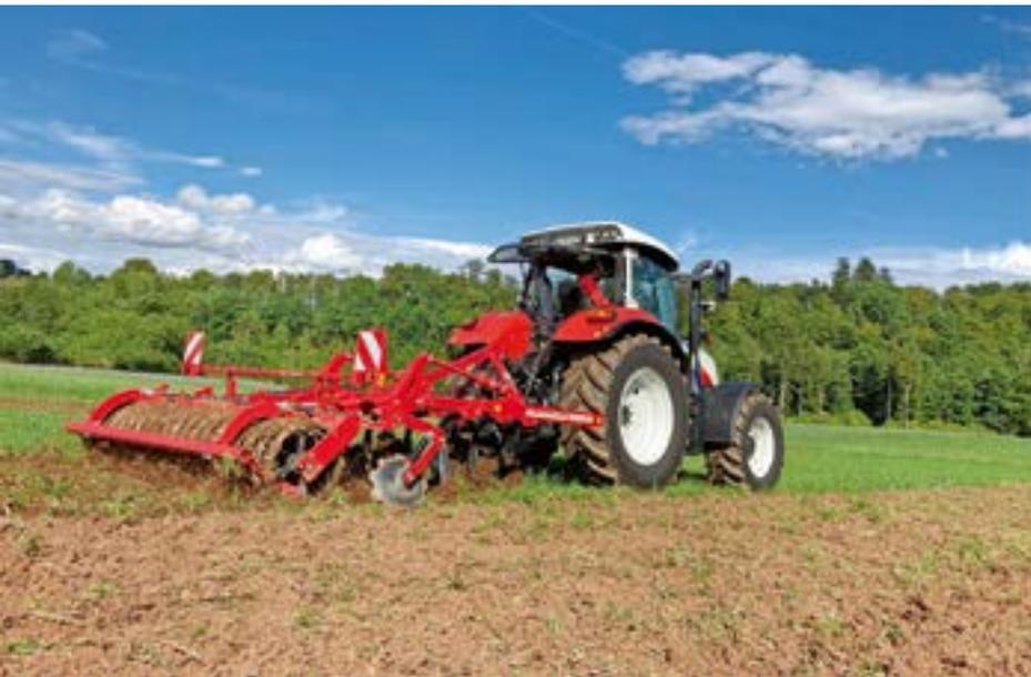
Celli Tiger Bio-Bodenfräse soll den Boden flach und ganzflächig bearbeiten. Die großen Tiefenführungsräder lassen eine präzise und flache Arbeitstiefeneinstellung zu. Ihre Arbeitstiefe liegt bei 2 bis maximal 10 cm. Durch die Ablage der Organik auf der Bodenoberfläche wird nach der Bearbeitung der Rotteprozess eingeleitet.
