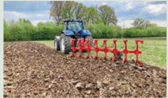
Ein Schälpflug des Herstellers Escudero als 8-Schar-Onland-Version bot die Möglichkeit, einen Versuch an fünf Standorten auf verschiedenen Böden anzulegen und mit einem herkömmlichen Pflug zu vergleichen.
