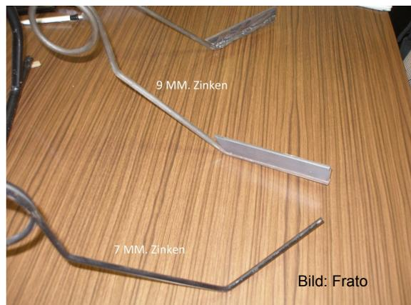
Bild 15: Neu: Torsionshacke mit Häufelblechen
