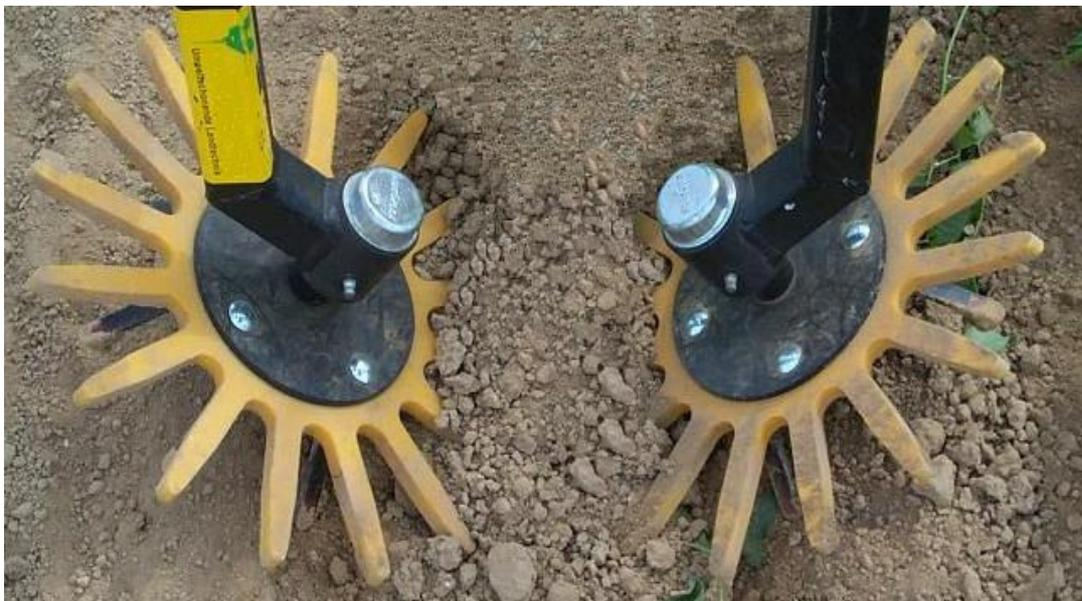
**Abbildung 10: Die Fingerhacke eignet sich gut zur Unkrautregulierung innerhalb der Pflanzenreihen**
