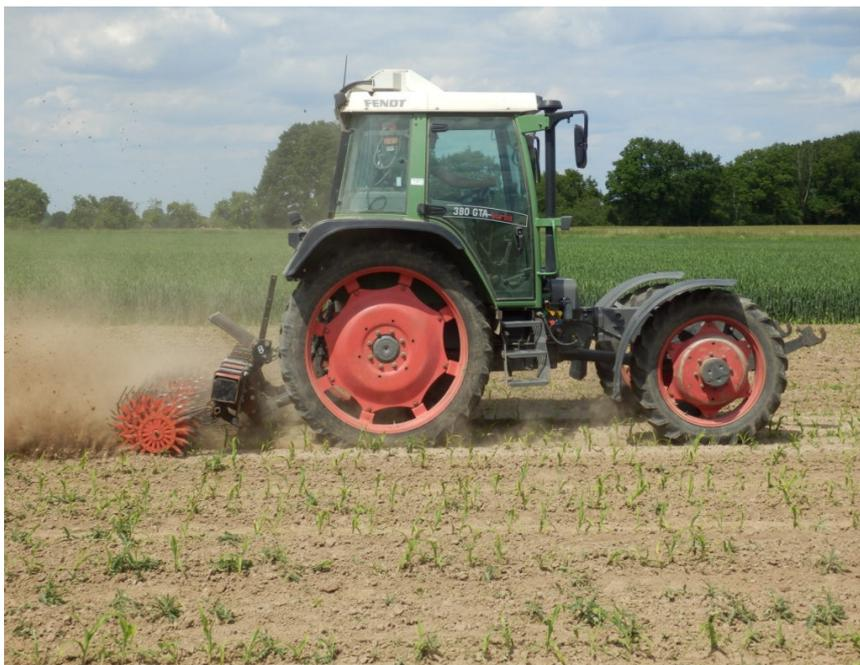
**Abbildung 7: Sternrollhacke (Rotary Hoe) im Einsatz**
