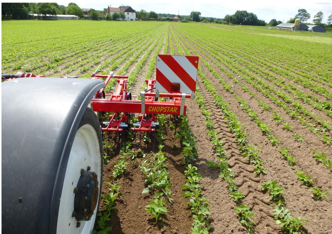
Abbildung 4: Einsatz der Front-Scharhacke mit Nachläufern in Sojabohnen
