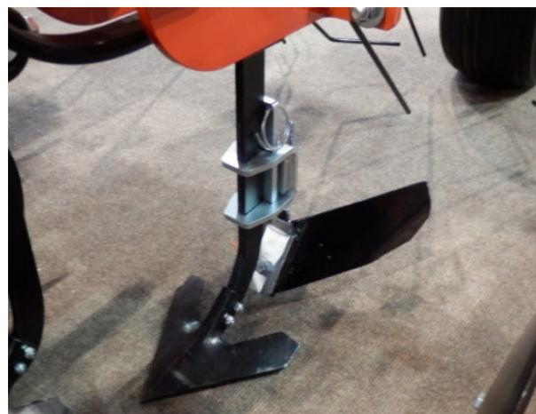
Abbildung 23: Aufgesteckte Häufelschare
