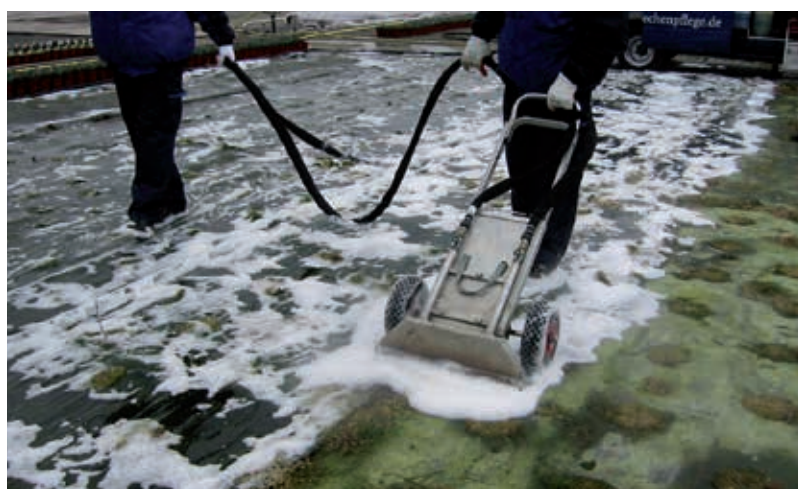
Das neuartige Heißwasserschäum-Verfahren dient der Unkrautregulierung und der Flächenreinigung. Bei dem zweistufigen Verfahren wird zuerst 95 °C heißes Wasser ausgebracht und darüber ein natürlicher, vollständig abbaubarer Schaum gelegt, der die Wirkungsdauer des heißen Wassers verlängert, indem er dessen Abkühlung verzögert.
