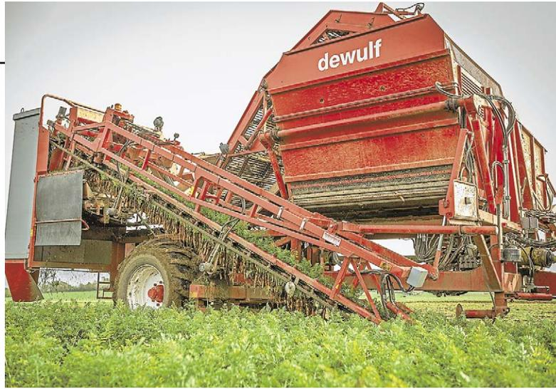
**Der schlepperangetriebene Klemmbandroder zieht die Möhren aus der Erde. Damit dies ohne Probleme abläuft, muss das Laub intakt sein.**
