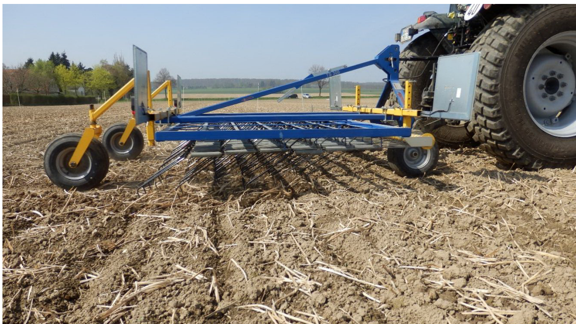
Abb. 14: Beim Querstriegeln im Keimblattstadium sind erhöhte Rübenverluste zu erwarten. Gut sichtbar sind die Särillen der Fingerdruckrolle
