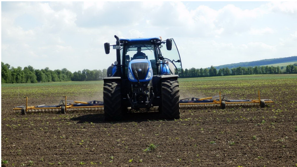
Abb. 19: Striegeln quer zur Särichtung mit Breitreifen und 0,6 bar Reifendruck
