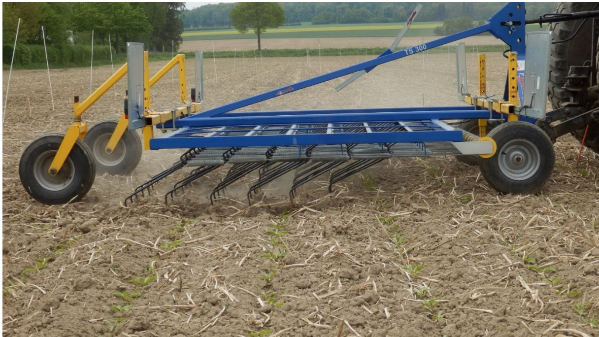
Abb. 17: Striegeln quer zur Särchtung im Stadium 1. Laubblattpaar (BBCH 12)
