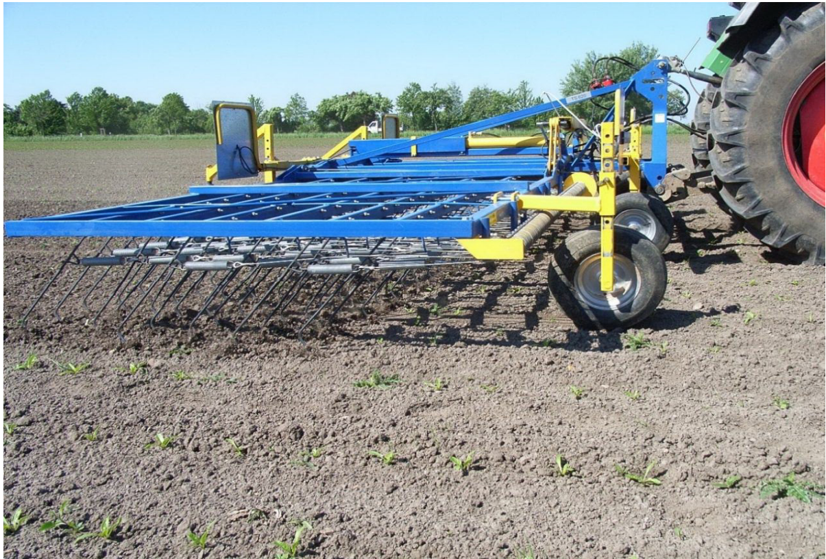
Abb. 3: Striegel des Herstellers Treffler mit indirekter Federung der Zinken
