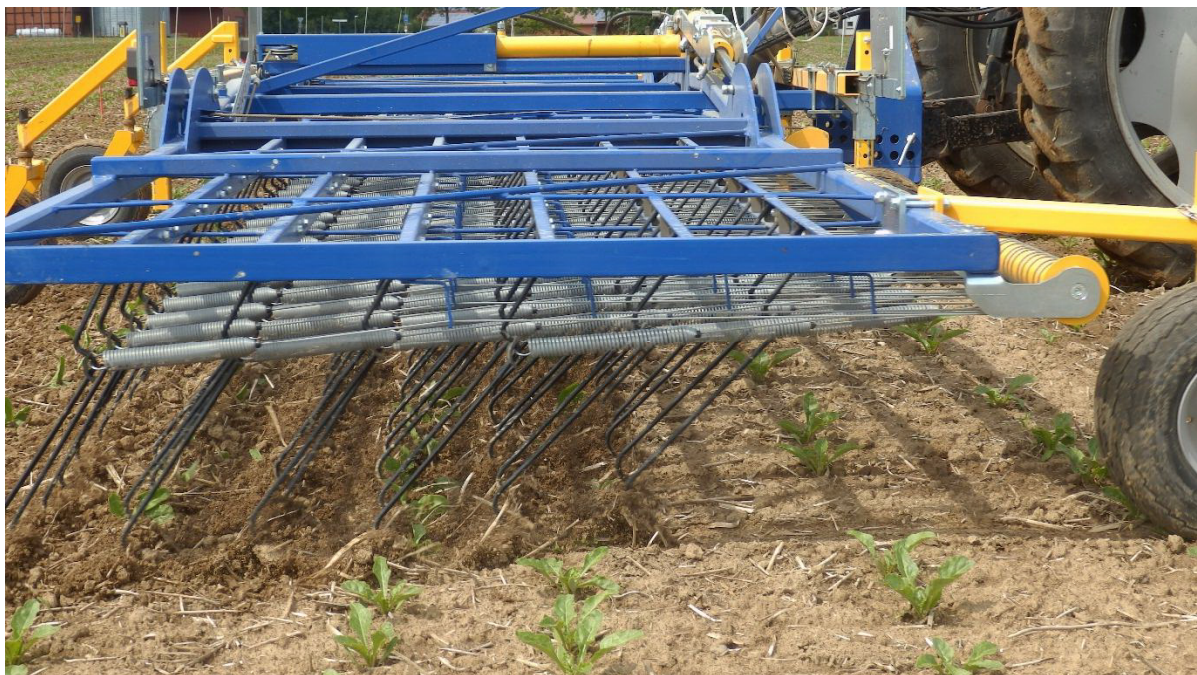
Abb. 18: Striegeln quer zur Särchtung im Stadium 2. Laubblattpaar (BBCH 14)
