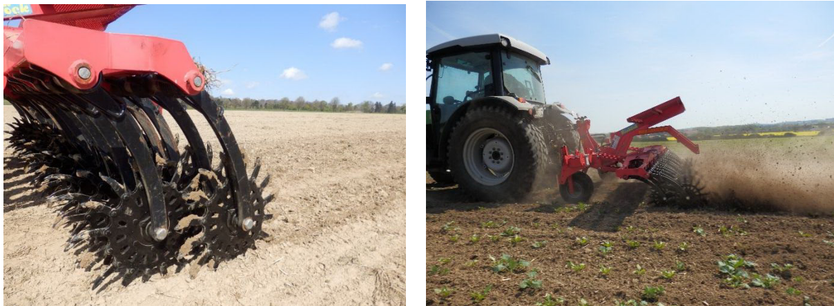
Abb. 20: Einsatz der Sternrollhacke in Zuckerrüben
